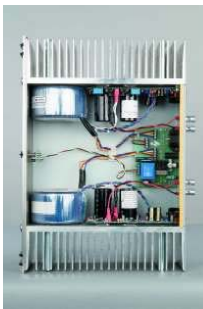
Końcówka mocy – dual mono i pełna symetria.
