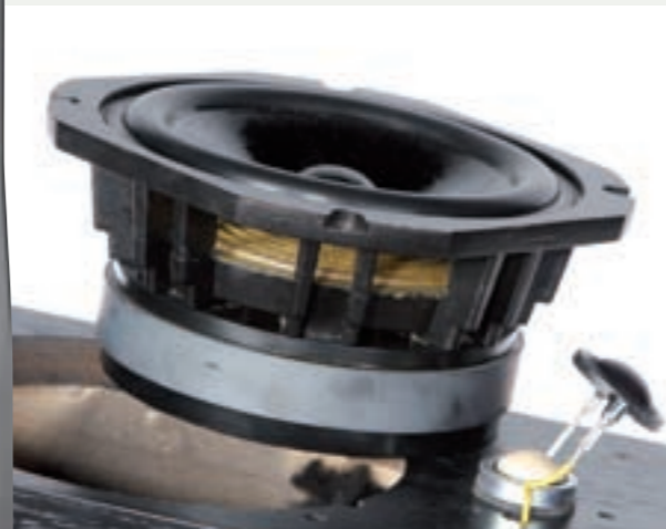
GUTE GENE: Der unglaublich starke Antrieb des Tieftöners erinnert an Beschallungstechnik. Die Gewebekalotte mit Filzbedämpfung ist dagegen klassisches HiFi.
