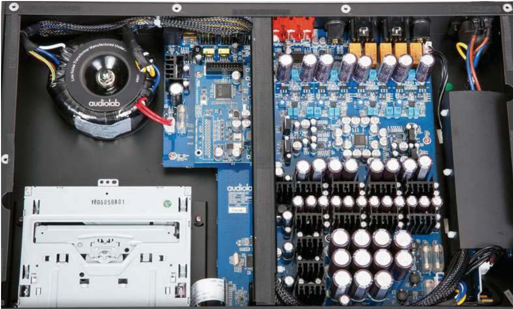
Beim Audiolab verblüffen zwei arbeitsteilige Netzteile, die Batterie von Siebelkos und die allgemeine Fülle im Gehäuse – vor allem angesichts des Preises von knapp 1500 Euro.
