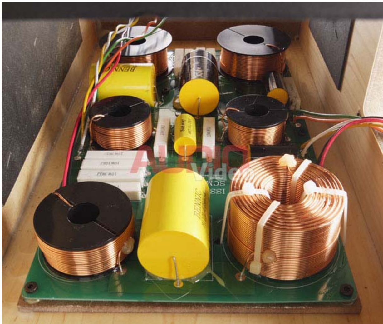
Zwrotnica złożona, jak przystało na kolumnę trójdrożną. Jakość podzespołów ? wyborna
