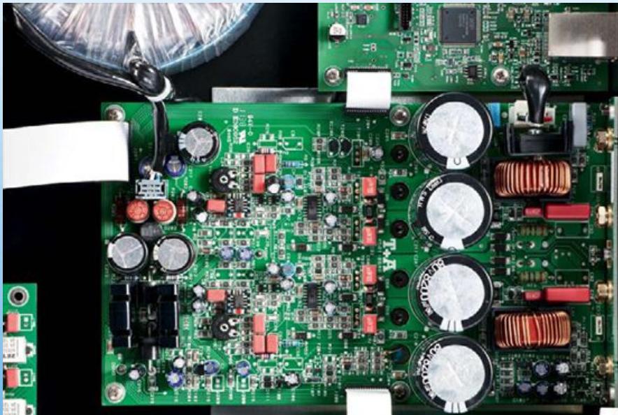
AUF DIE PLÄTZE: Das Innenleben der T+A-Komponenten – hier die Endstufe des PA 1000 E – ist wie gewohnt wie geleckt. Hochwertige Bauteile aus der Industrie-Elektronik gewähren lange Lebensdauer. Rechts die für Schaltverstärker typischen Spulen.
