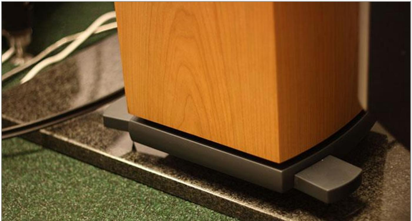
Jednoduchá výhybka rozděluje pásma, tak jak je u třípásmovek ATC tradicí, na úrovních 380 a 3 500 Hz. Reprosoustavy mají velmi nízkou citlivost 85 dB / W / m a i když výrobce tvrdí, že mají rovnou impedanční křivku a není tak třeba vysokých proudových rezerv u zesilovače, budete potřebovat hodně Wattů na jejich rozhýbání. Z doporučeného rozsahu 75 - 300 Wattů výkonu bude jen dobré, čím blíž budete u svého zesilovače té vyšší hodnotě. Deklarovaná impedance činí 8 Ohm.
