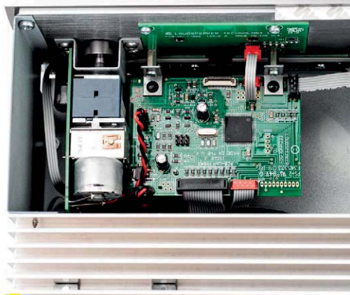
Za regulację głośności odpowiada klasyczny potencjometr Alpsa.
