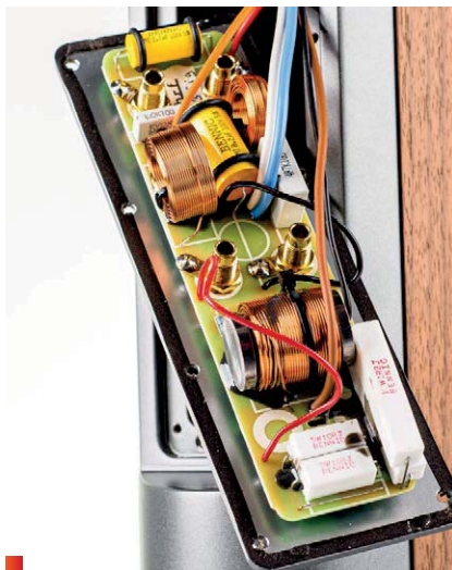
Zwrotnicę, tak jak poprzednio, zamontowano na aluminiowej płytce terminali. Układ komponentów i one same wyglądają znajomo.
